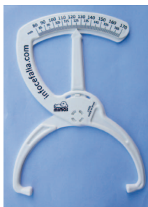
Fig. 12 – Craniòmetre Infocefalia. Dissenyat per l'enginyer David Verde, aporta importants modificacions al clàssic cefalòmetre de Bertillon. No només per les seves dimensions, més fàcilment maneigable, i el seu cost, molt més econòmic, sinó per aplicar conceptes matemàtics que corregeixen la medició de fragments de circumferència, com fa el Bertillon, convertint-los en mesures lineals equiparant-les a les obtingudes sobre fotografies, recurs habitual en neurocirurgia, transformant-lo en un estri imprescindible per fer el seguiment a l'Atenció Primària.
